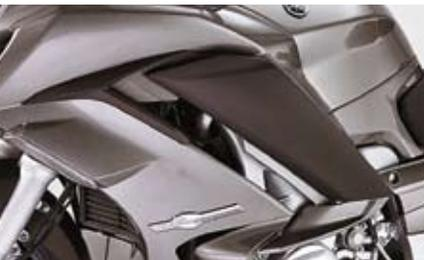
Werkzeuglos lassen sich die Einsätze der Seitenverkleidung nach außen versetzen, um den Wetterschutz im Beinbereich zu vergrößern.
