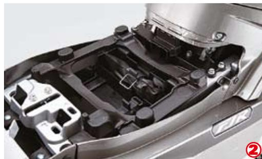
1 Unter Alu-Blechen sitzen die Einstellschrauben für die Lenkerhälften. 2 Die Sitzhöhe wird durch Versetzen des Kunststoffträgers variiert.
