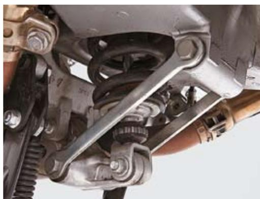
Stärkere Federn für die beiden Optionen »Hard« und »Soft« sowie etwas mehr Dämpfung hat man auch dem progressiv über Hebel angelenkten Zentralfederbein spendiert. Wie bisher auch kann nur die Zugstufe eingestellt werden.
