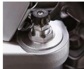
Neue 48er-Telegabel mit progressiven Federn und deutlich erhöhten Dämpferkräften. Zug- wie Druckstufe werden nur am rechten Holm eingestellt, die Federvorspannung auf beiden Seiten.
