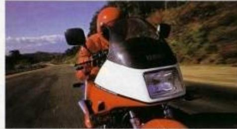
Das aerodynamische Profil der FJ1100 wird durch eine rahmenfeste Halbschalenverkleidung sowie einen Motorspoiler bestimmt. Mit einem Spoiler versehen wurde ebenfalls die Heckverkleidung der FJ1100.
