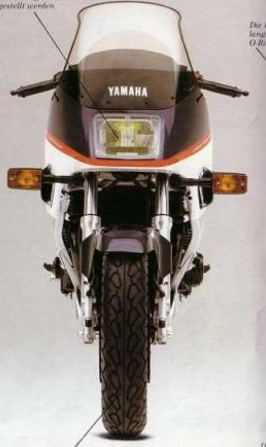
Die FJ1100 rollt auf 16 Zoll-Rädern. Sie besitzt extrem breite Niederquerschnittsreifen: Vorn 120-80 V16 und hinten 150-80 V16.
