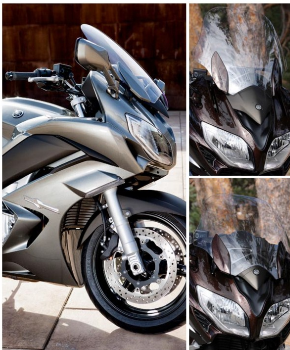
Kåbeglassets ophæng og den trinløse, elektroniske justeringsmekanisme er hhv. lettere og hurtigere. Kåbeglasset er nydesignet, og det bliver nu i den valgte position, når man slukker for tændingen.
