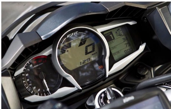
FJR's nye 3-delte instrumentpanel er lavet med inspiration fra luksusbilindustrien – med centralt placeret digitalt speedometer, analog omdrejningstæller til venstre og multifunktionsdisplay til højre.
